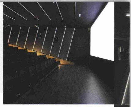
con schermo diffusore in opale piatto trasparente, utilizzate in dimmerazione 20%-40% con le prime. Per quanto riguarda le LED strip a luce bianca (c) queste sono state destinate per l'illuminazione interna di tutte le sale, con una esecuzione realizzata appositamente con una più bassa potenza e un fattore di interdistanza (LED/metro lineare) più alto, per mascherare l'effetto puntinato percepito dai fruitori delle sale, in quanto posizionate a vista e ad altezza occhi spet-
